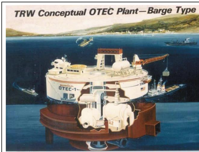
圖 2.6 美國 TRW 公司設計的商業化浮台式溫差電廠(圖片引用自科學發展 2004 年 11 月，383 期)
